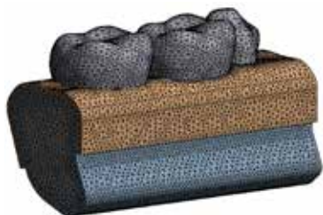
Рис. 2. Скінченно-елементна сітка математичної моделі нижньої щелепи з дентальним імплантатом
