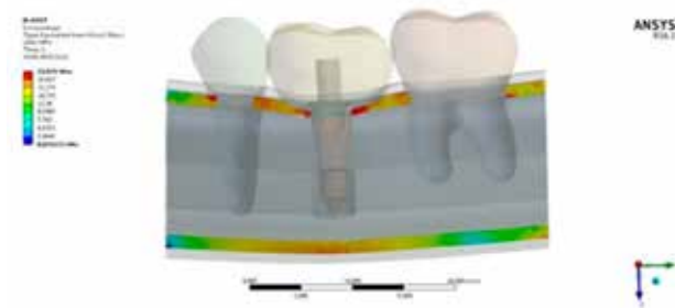
Рис. 4. Розподіл навантаження в кортикальній кістці з використанням імплантата моделі NeO
