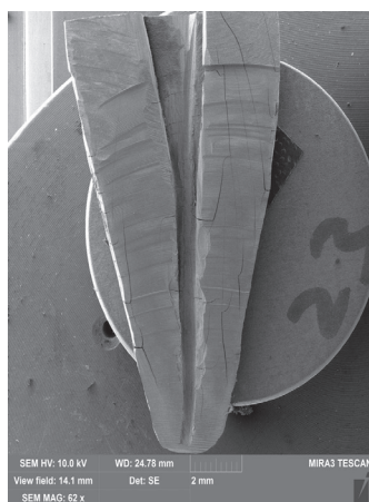
Рис. 7. Зразок половини кореня зуба готовий до SEM. Поверхня покрита тонким шаром золота методом напилання товщиною 50–100Å (SEM-фото, x62x).
