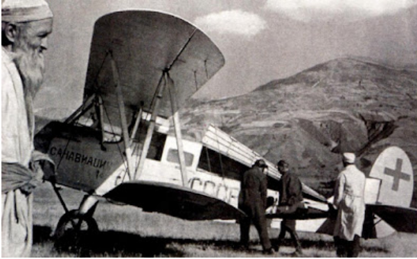
Рис. 1. По-2С, Памір. Відкинутий дах фюзеляжу для хворого на ношах, перед ним кабіна лікаря, перед якою відокремлена кабіна пілота
