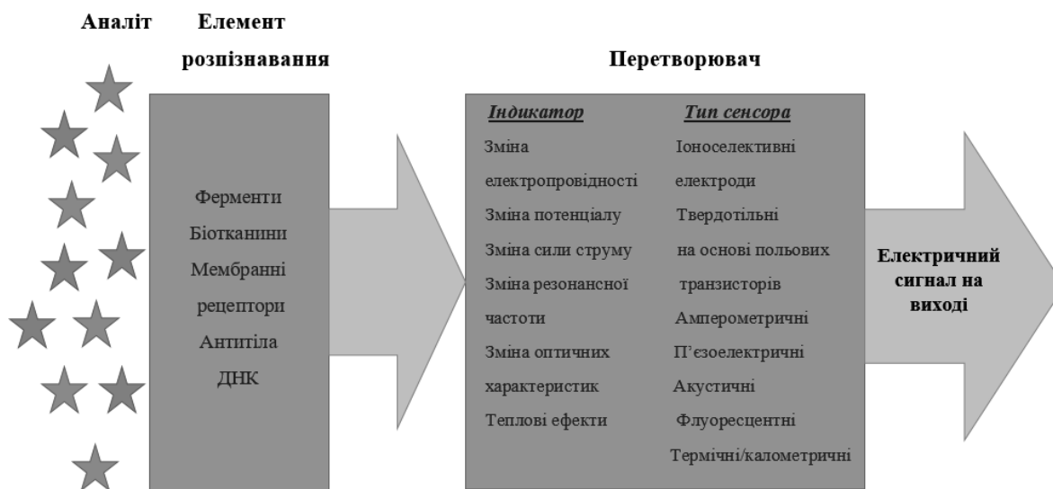
Рис. 1. Структурні елементи типового біосенсора.
