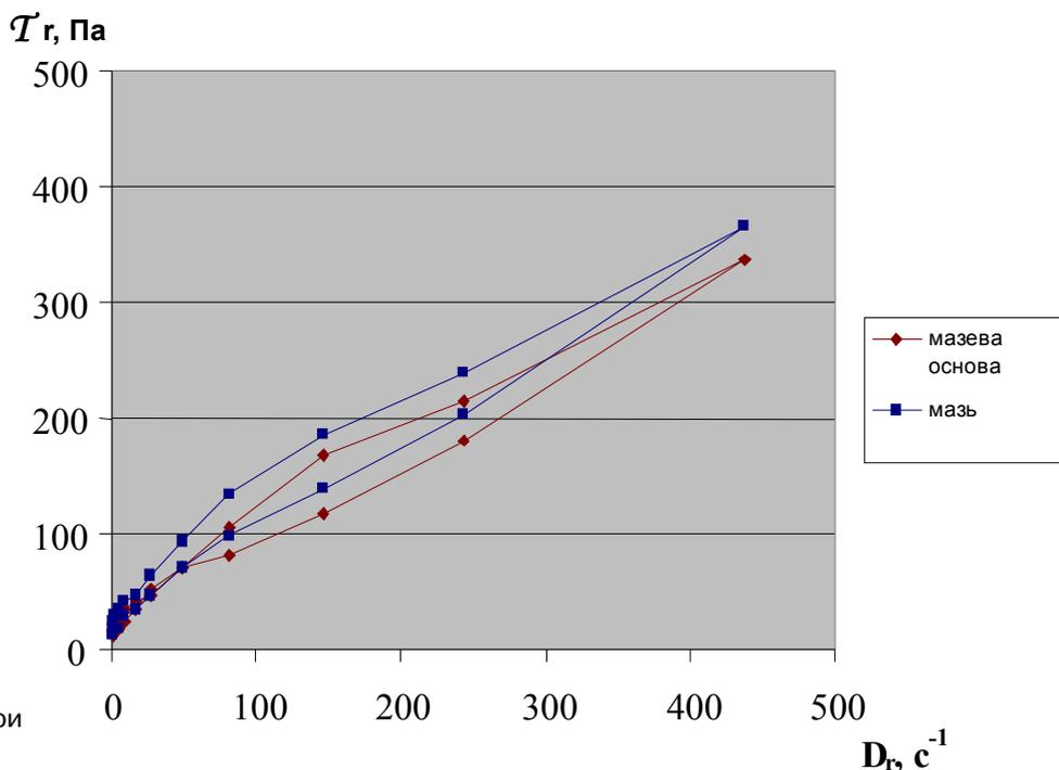
**Рис. 2.** Залежність напруги зсуву від швидкості зсуву зразка мазі та маzewої основи при температурі 34 °С.
