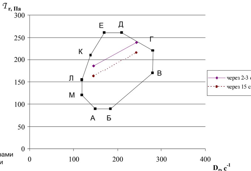
Рис. 4. Обмежені реограми плинущу зразка мазі при температурі  $34^\circ\text{C}$ .
