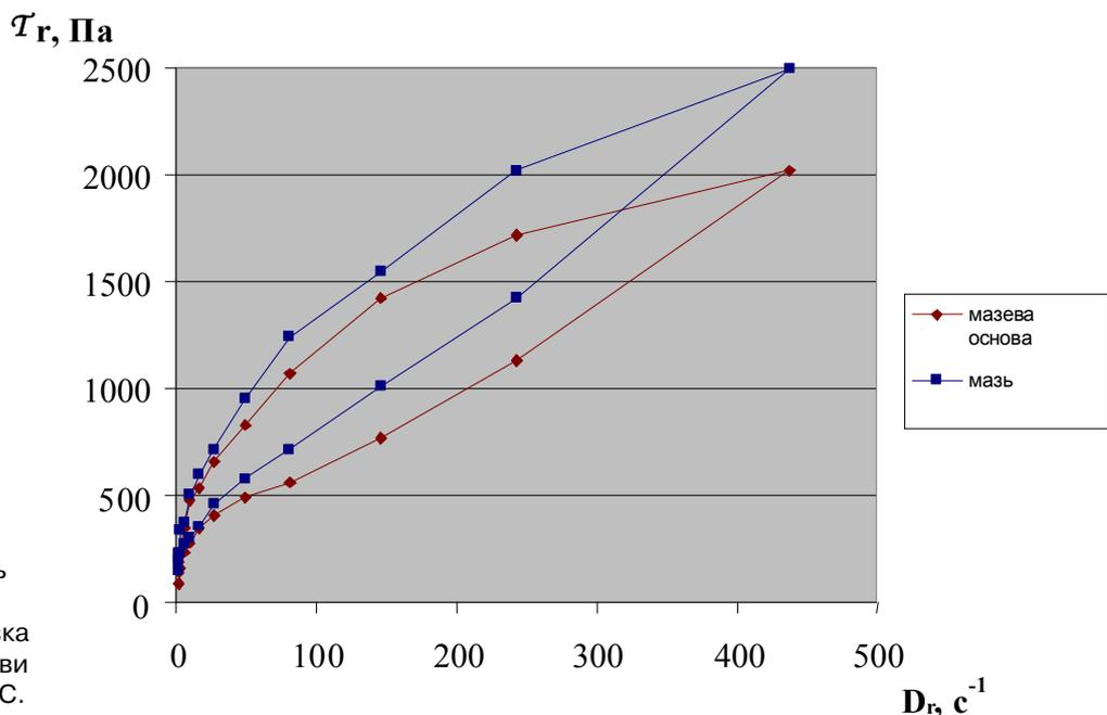
**Рис. 1.** Залежність напруги зсуву від швидкості зсуву зразка мазі та мазевої основи при температурі 20 °С.
