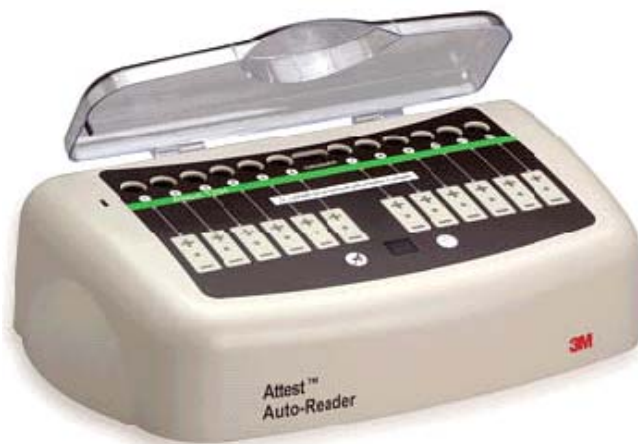
Мал. 3. Автоматизований інкубатор-вимірник для термостатування й аналізу рівня флуоресцентного світіння індикаторів швидкої дії.
