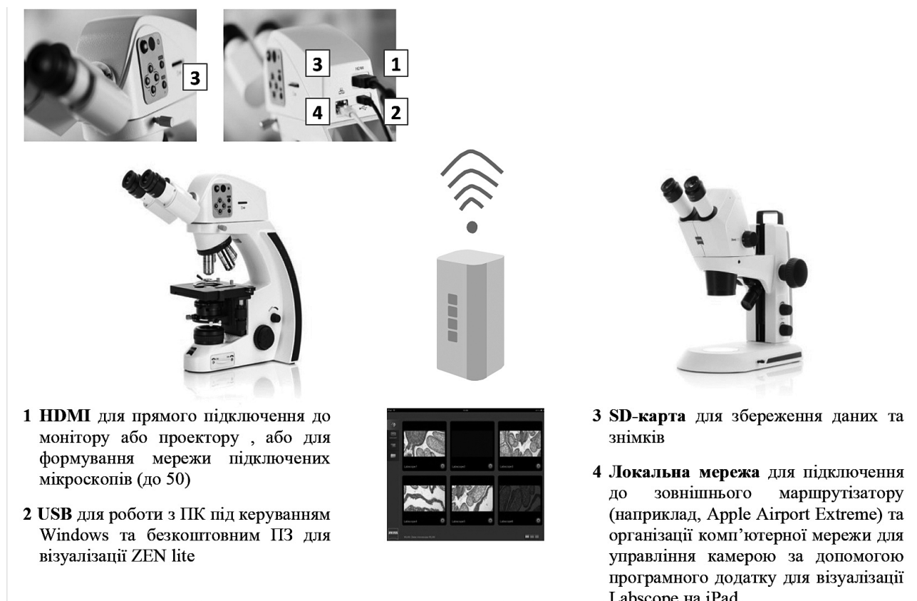
Рис. 2. Використання інтерфейсів ZEISS Primo Star
