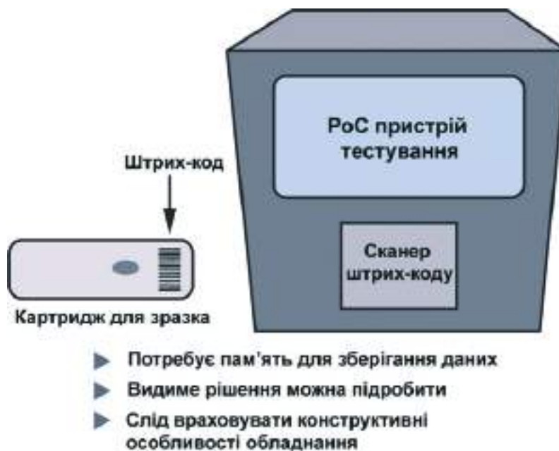
Рис. 19. Пристрій для обробки зразків після тестування з вбудованим сканером штрих-кодів
