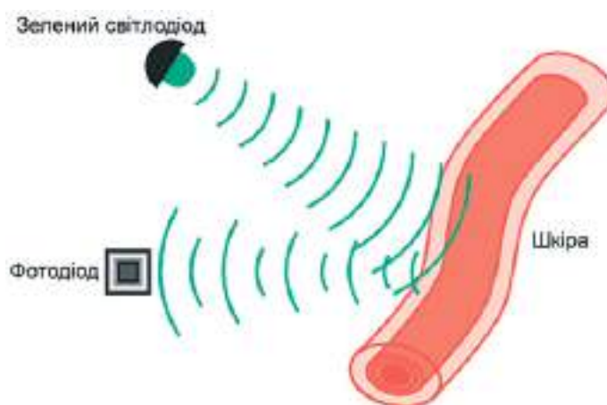
Рис. 4. Принцип вимірювання частоти серцевих скорочень і сатурації
