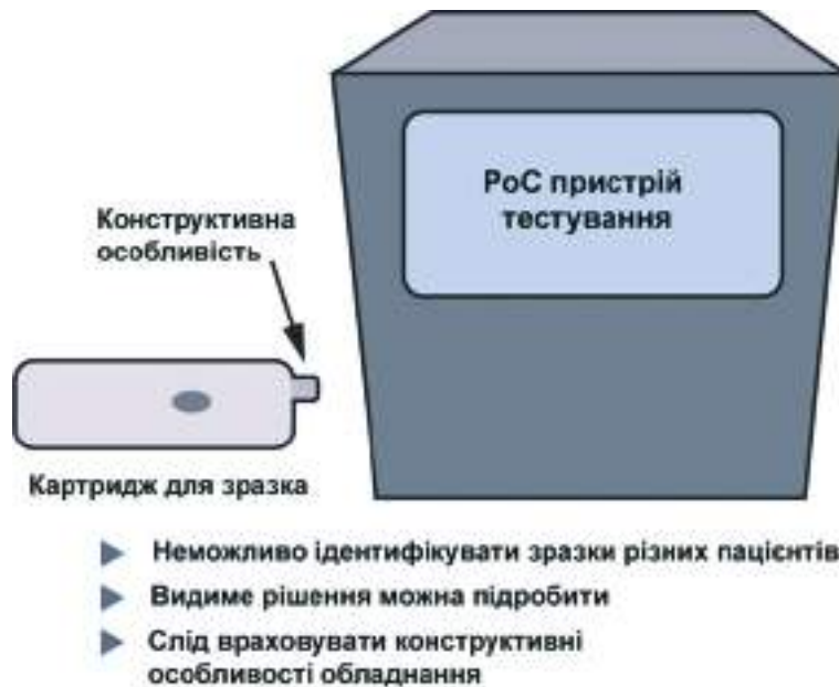
Рис. 20. Пристрій для обробки зразків після тестування з вбудованою механічною виїмкою на тестовій системі
