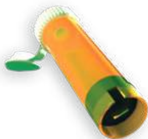
Рис. 15. Картридж із вбудованим наносенсором
