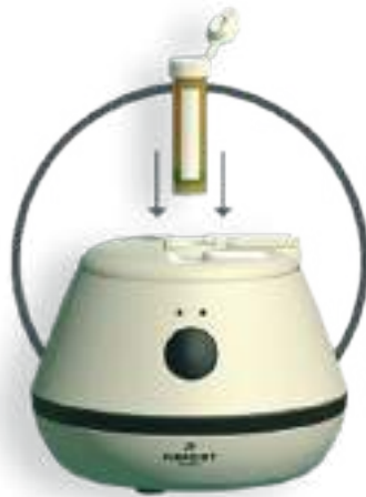
Рис. 16. Крок 1: картридж з наносенсором вставляється у зчитувач
