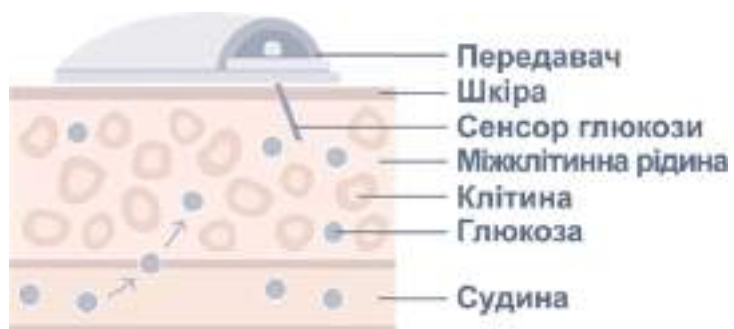
Рис. 33. Принцип дії мікросенсору в складі монітору рівня цукру в крові
